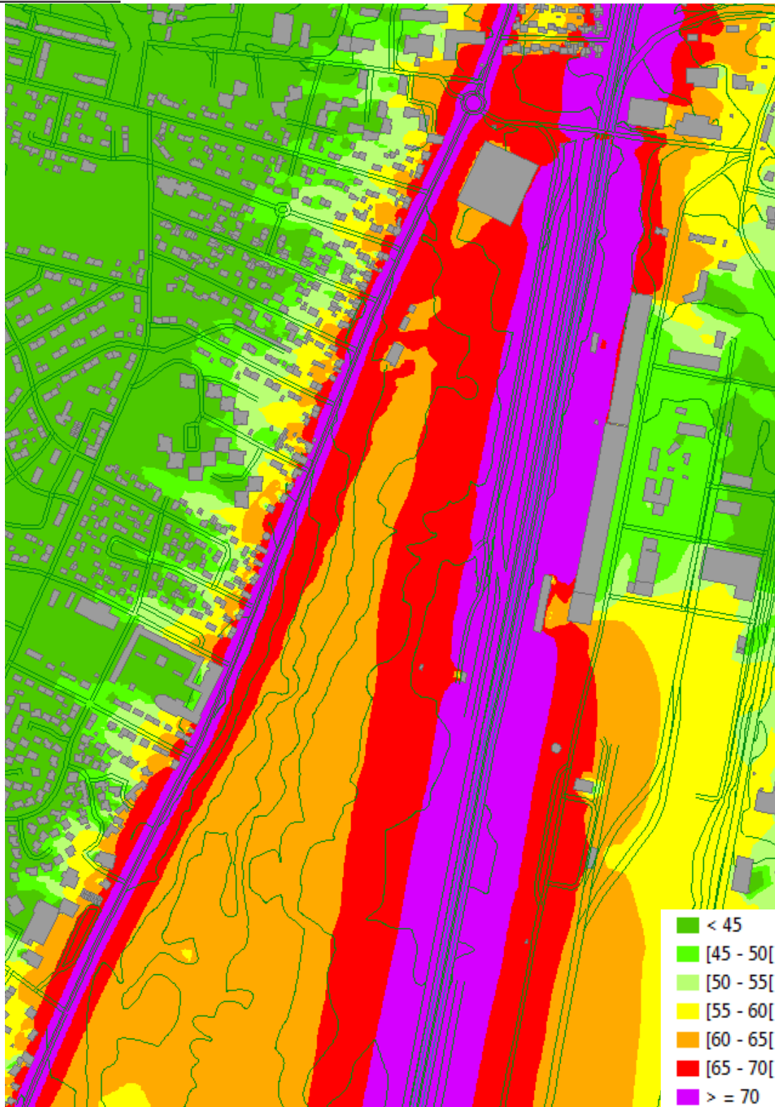
Figure 10: Carte de bruit de la situation actuelle à terme (2035) sur la période 6h-22h (hauteur 4m), L_{Aeq} en dB(A)
